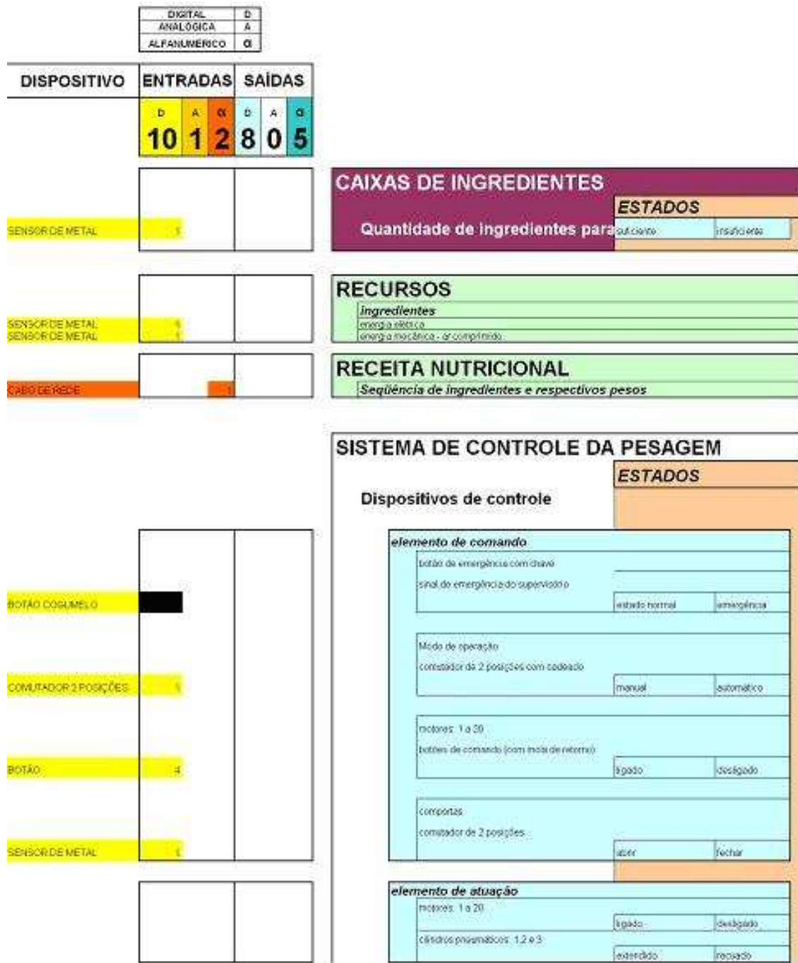
Figura 19: Levantamento das entradas e saídas do protótipo em CLP
